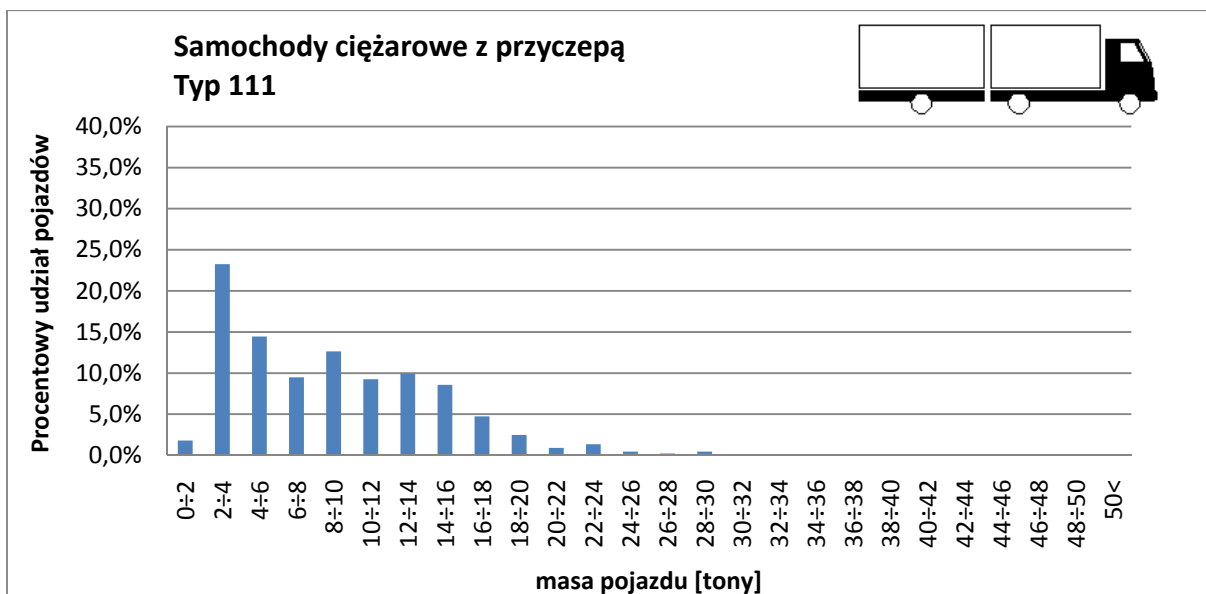
Rysunek 4.13. Rozkład masy samochodów ciężarowych z przyczepą typu 111 – stacja Wola Dębińska
