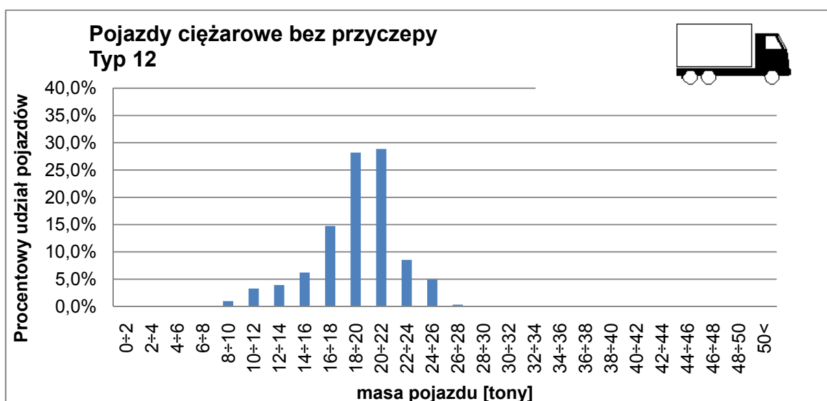
Rysunek 4.44. Rozkład masy samochodów ciężarowych bez przyczepy typu 12 stacja Byczyna
