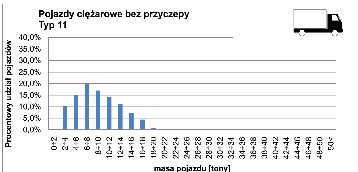
Rysunek 4.43. Rozkład masy samochodów ciężarowych bez przyczepy typu 11 stacja Byczyna
