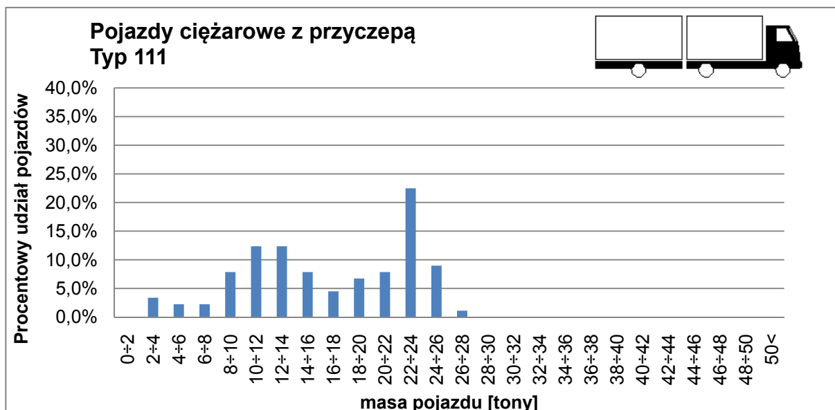
Rysunek 4.48. Rozkład masy samochodów ciężarowych z przyczepą typu 111 stacja Buczyna
