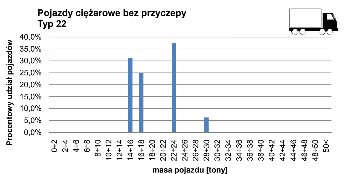
Rysunek 4.45. Rozkład masy samochodów ciężarowych bez przyczepy typu 22 stacja Byszyna
