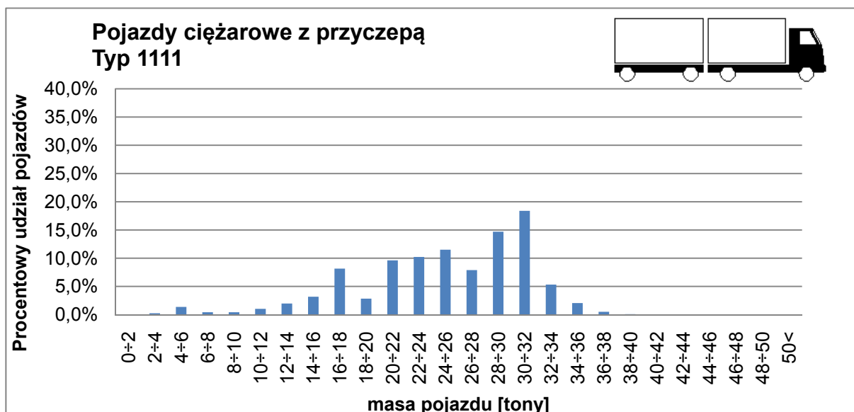
Rysunek 4.47. Rozkład masy samochodów ciężarowych z przyczepą typu 1111 stacja Buczyna
